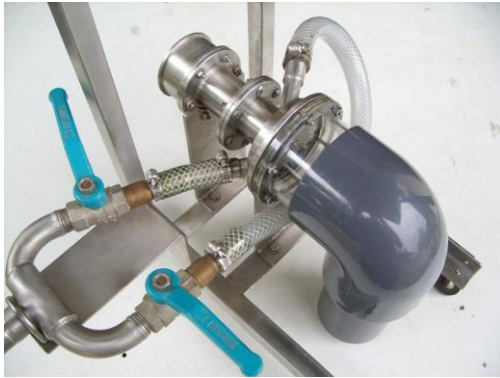
รูปที่ 3-15 รูปร่างกังหันแบบอิมพัลส์เทอร์ไบน์แบบไหลตามแนวแกน เพื่อการศึกษาของ ESSOM
